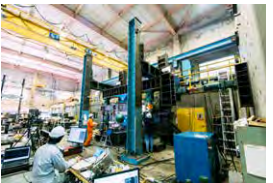
02 | 構造実験棟 実際の柱や梁の耐震性を測る加力装置など、国内有数規模の実験設備を備え、最先端の教育が行われています。
